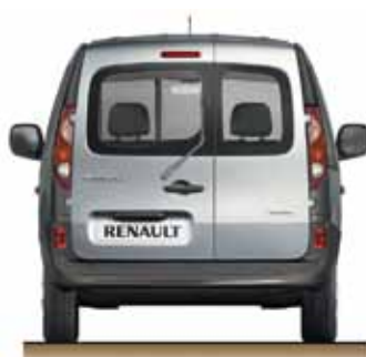
ASIMETRISKAS AIZMUGURES DURVIS AR STIKLOJUMU, AR STIKLA TĪRĪTĀJU UN LOGA APSILDI
